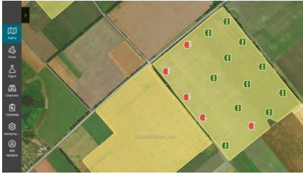
Рис. 4. Приклад відображення проведених вимірів ущільнення автоматичним пенетрометром
