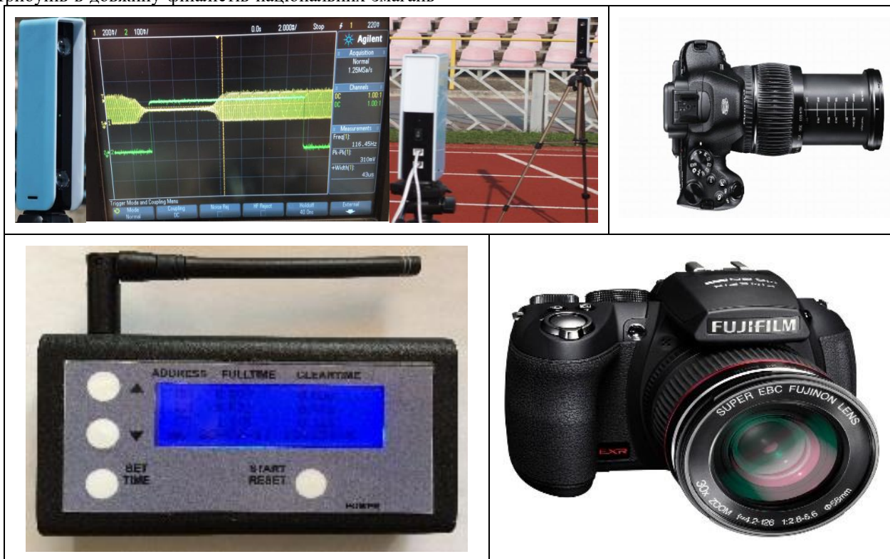
Рис. 1. Електронно-оптична система «старт-фініш» (час затримки вихідного сигналу від моменту перетинання променю – менш ніж 0,001с); цифрова фотокамера Fine-Pix HS20EXR
